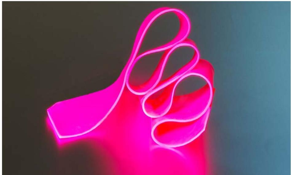
Mit dem Vitalit UV 4802 brachte Panacol einen besonders flexiblen Klebstoff auf den Markt. Er ist speziell für das Verkleben von hochtemperaturbeständigen thermoplastischen Kunststoffen geeignet. Es handelt sich um einen einkomponentigen Klebstoff, der unter Lichteinwirkung extrem schnell aushärtet. Er zeichnet sich durch eine hohe Haftung auf vielen, mit herkömmlichen Klebstoffen oft schwierig zu verklebenden Kunststoffen aus.
