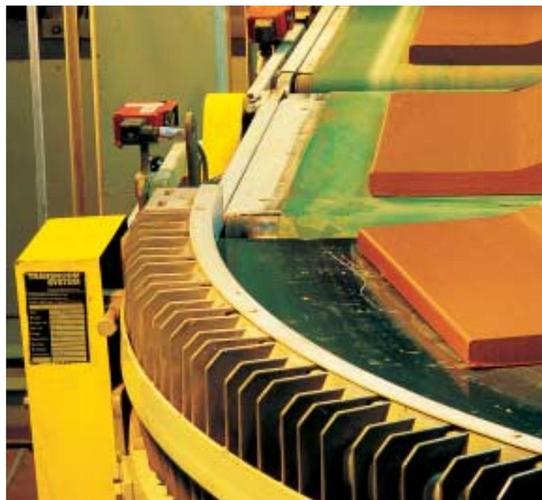
Pfannenziegel- und Zubehörfertigung wird der Tonstrang in einem Zwischenschritt in Pressrohlinge unterteilt,
