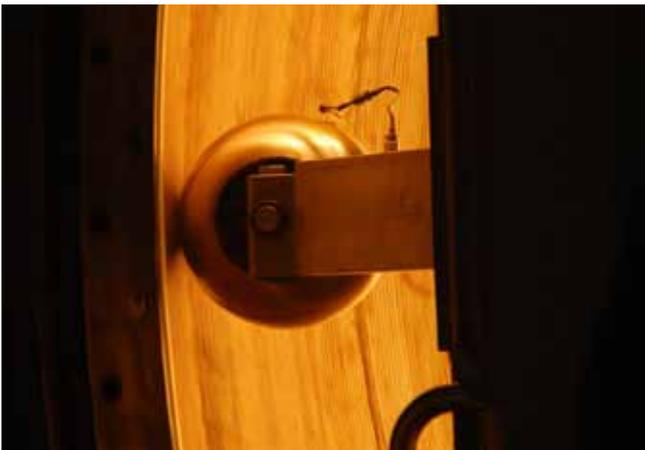
Tankdome während des Rührreißchweißens bei MT Aerospace in Augsburg
