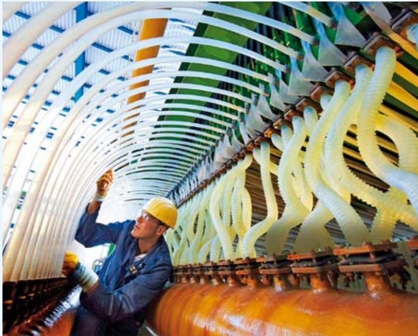
Betriebsassistent Jörg Bähler prüft Einleitungsrohre an der von Bayer mitentwickelten Sauerstoffverzehrkathode, die rund 30 Prozent Energie bei der Herstellung von Chlor einspart.
